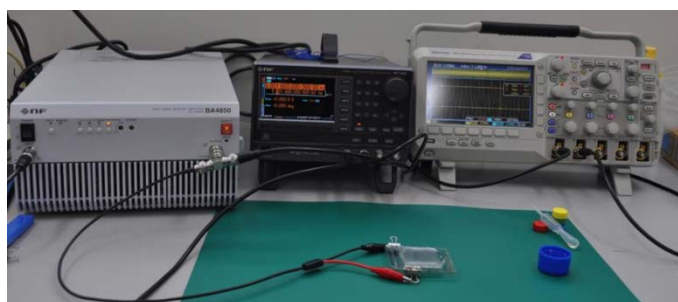
図6 共振周波数計測試験
