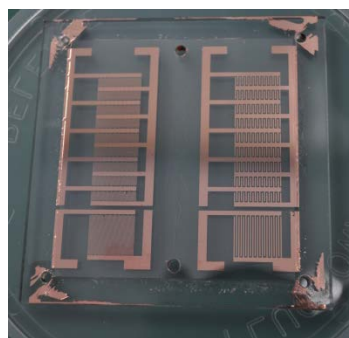
図5 ニオブ酸リチウム+ポリスチレンデバイス
