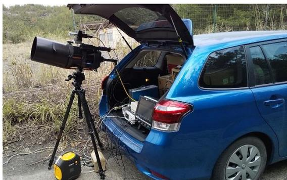
図5 フィールド観測時(2020/3/13)の桜島火山とその噴煙 図6 開発した自動車で移動可能なパーティクルカウントライダー(観測時の様子)
