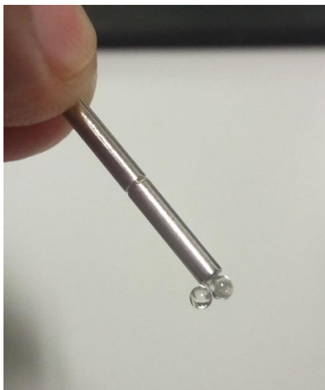
Figure 1. 磁石につく 60\text{Gd}_2\text{O}_3\text{-}40\text{B}_2\text{O}_3 ガラス。
