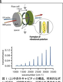
図 1 (上)中赤外キャビティの構造。将来的なポンププローブ実験を睨み、可視光を透過する窓材を用いる。(下)キャビティを投下した中赤外光の透過スペクトル(シミュレーション)
