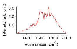
図3 AgGaS2 結晶による差周波発生によって 発生させた中赤外フェムト秒光源のスペクト ル。
