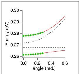
図 2 DPPA(neat liquid)を試料とした場合に 観測された振動ポラリトンの分散曲線。黒点 線はキャビティと振動モードの分散曲線。 赤線はフィットの結果得られた振動ポラリト ンの分散。
