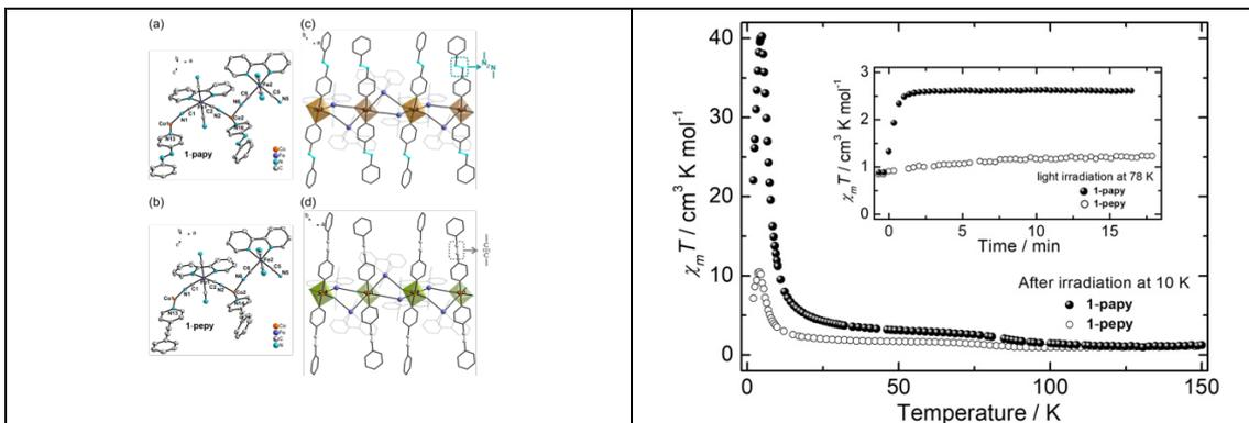
Figure 4.  $\{[\text{Fe}^{\text{III}}(\text{bipy})(\text{CN})_4]_2[\text{Co}^{\text{II}}\text{L}_2]\}$  の構造と光誘起準安定状態の磁性
