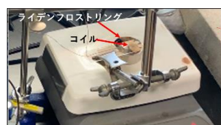
図 9. ライデンフロストリングを用いたエネルギー回収デバイスの試作
