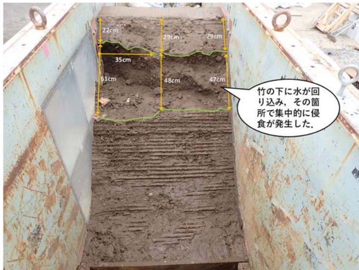
図 11 竹による侵食対策を実施した場合の侵食状況
