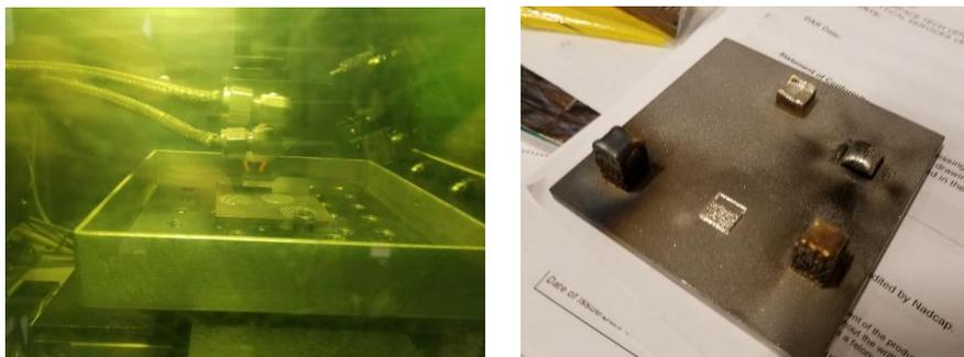
図1 指向性エネルギー堆積法の装置と、研修で作成した試験片
