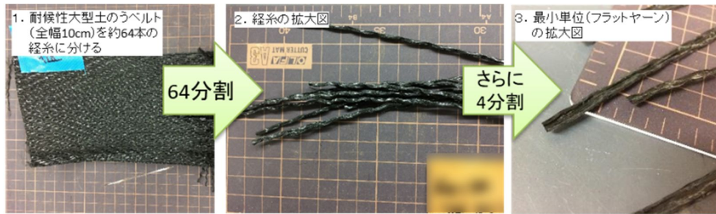
図 6 耐候性大型土のう吊ベルトをフラットヤーンに分解する手順
