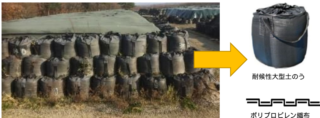
図 1 福島県内除染廃棄物仮置場と保管容器(耐候性大型土のう)
