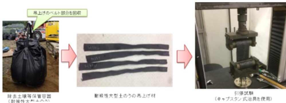
図2 耐候性大型土のう吊ベルトの引張試験の手順
