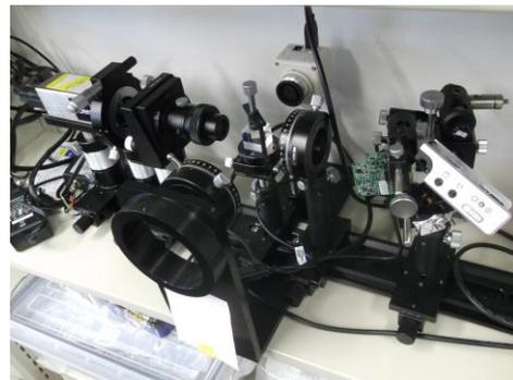
図 11 光制御型電子源アレイへのレーザー照射用光学系
