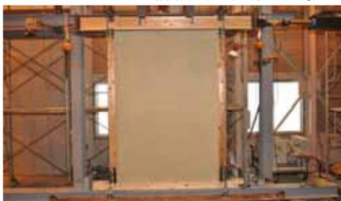
図3 土塗り壁の実大実験
