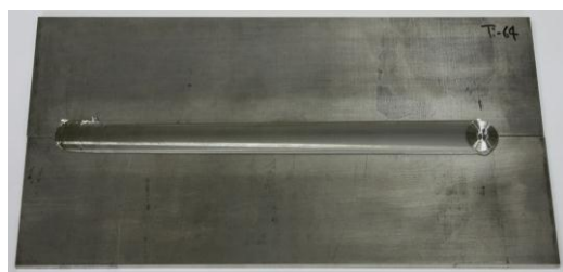
図3 FSWしたTi合金とCo合金ツールの試験前後の外観
