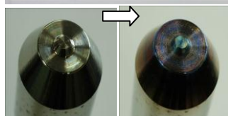
図3 FSWしたTi合金とCo合金ツールの試験前後の外観
