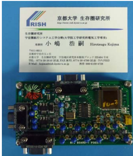
図 2 開発に成功したビジネスカードサイズ型波形捕捉受信器 (基板右上に開発したチップが搭載されている)。
