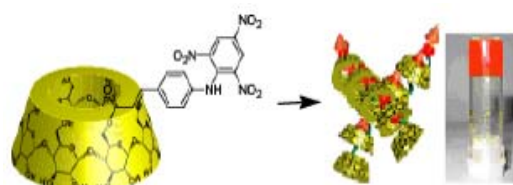
図 8. ゲスト分子を修飾した \beta -CD の線状超分子ポリマー形成とゲル化
