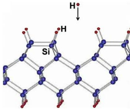
図9 計算に用いたSi(001)(2×1)-H表面構造モデル
