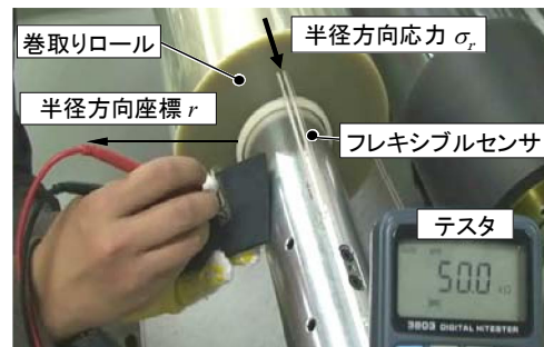
写真2(b) ひずみゲージによる半径方向応力の測定
