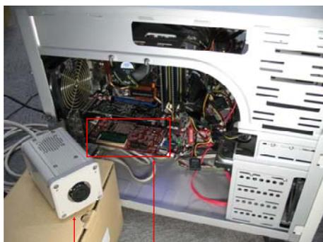
図6 CCD チップと FPGA により構成された知能バイオイメージャーの概観
