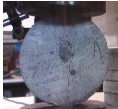
図-2 コンクリート中の高速ひび割れ進展
