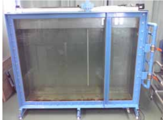
図 6 1m 長さのライザー管模型実験装置
