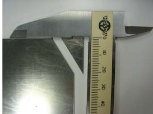
図 1 ジルカロイ 4 の切断結果
