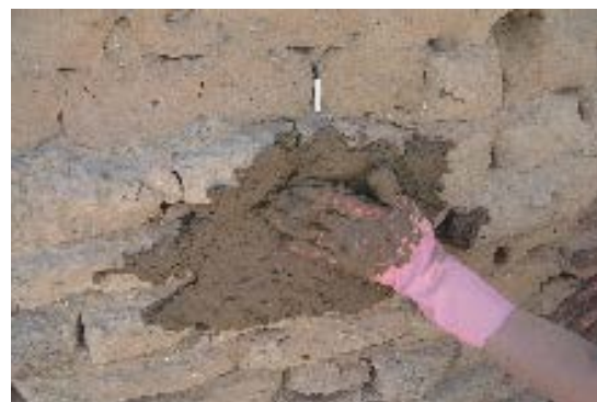
図4. 日干レンガ壁へのスカイメタル埋込み実験
