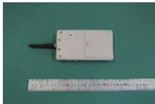
図3. 試作した耐候型ミューチップリーダー
