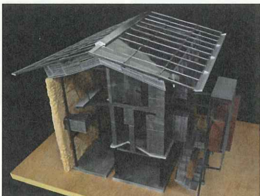
図6. 建築デザインワークショップA-1の模型。マジア既存石造躯体を自律的に残存させ、その内、外に新設の鉄骨壁体を密接して挿入、敷設。
