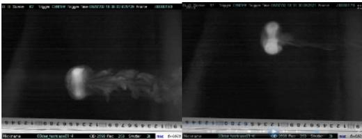
図 7 開口径の形状による渦輪安定性への影響。(左)通常開口，(右)内傾 30 度エッジを持つ開口。シミュレーションと同様，内傾エッジを持つ方が渦輪の濃度が高い。
