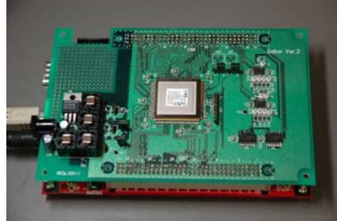
図 8 : ガボールフィルタ LSI と制御用 FPGA (下側基板)
