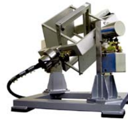
図 1 三次元重力分散型模擬微小重力発生装置 (3D-クリノスタット)
