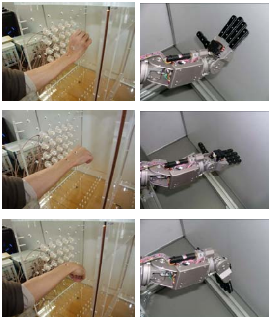
図 7 手首の動きの検出と、その動きを反映させるためのロボットアーム
