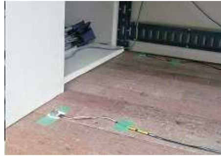
荷室床上加速度ピックアップ設置画像
