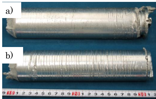
Fig.5 Al-6%Si 合金超音波振動連続铸造法で作製した铸塊. a)振動付加なし, b)超音波振動付加
