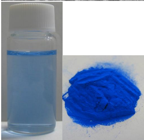
図2 (上)超臨界水熱合成した \text{CoAl}_2\text{O}_4 ナノ結晶の TEM 像。(右下) 有機溶媒中に分散したナノ結晶分散液。(左下) 乾燥状態の”コバルトブルー” ナノ結晶
