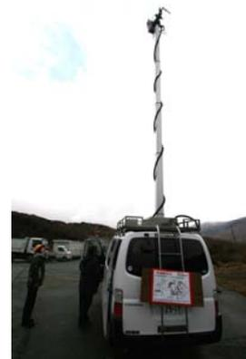
に取り付けられ、伸長時の高さは車体の荷台分を含めて約 8m である。その先端には指向性アンテナの方向を変えるため、電動雲台が据え付けられている。ほかの無指向を含め、アンテナ類は全てこの雲台に同架され、車輛走行時は雲台ごと外して車内に収納する。アンテナと雲台につながるケーブル類は、車体側面のコネクタボックスを介して車内機器類とつながれ、走行時は屋根に配されたケースに収納される。搭載した機器類の電力は、伸縮ポールを除いて車外の発電機から供給されるが、車体バッテリーから供給される電源を交流 100V に変換するコンバーターも装備しており、簡単な動作確認などは発電機なしで行える。
