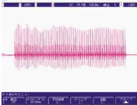
図 3 マルチバンチビームの実測データ (100bunch/pulse)
