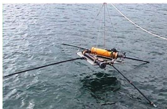
図 5 : AMT-OBEM の試作機
