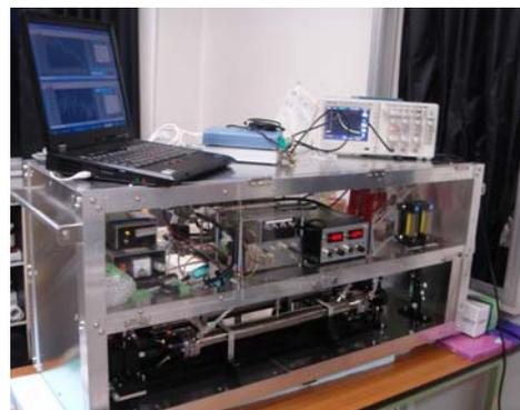
図1: 開発したCRDSエアロゾル消散係数計測装置の概観
