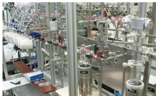
図2 本研究で作成した微量グラファイト精製用ガラスライン
