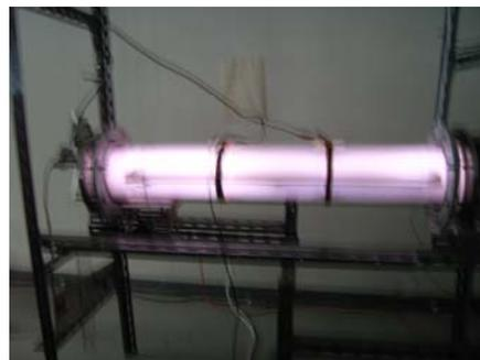
図 5. YCOPEX 内に広がるアルゴンプラズマ。中に水平に設置されたステンレス板 (ガラス管の下方に黒く見える) 上にシースができる。ガラス管内に設置された微粒子供給装置から吐き出される微粒子がシースープラズマ境界面に浮遊する。
