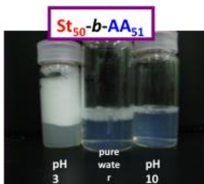
図2 ポリスチレン- b -ポリアクリル酸ジブロックコポリマー水溶液の起泡性の pH 依存性。ポリアクリル酸のカルボキシル基が解離してアニオンとなる中性およびアルカリ性では界面不活性となるが、解離しない酸性では界面活性を示す。
