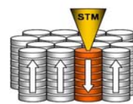
図 3. 超高密度記録 (カラム集合体ごとに微小電極で反転できる)
