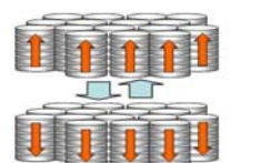
図 2. 強誘電性柱状液晶相 (電場により分極反転し, 電場除去後も分極が維持する)
