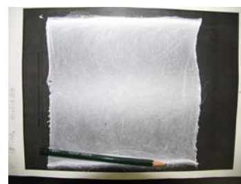
図3 炭酸ガスレーザー超音速マルチ延伸法で作製した PLLA ナノシート
