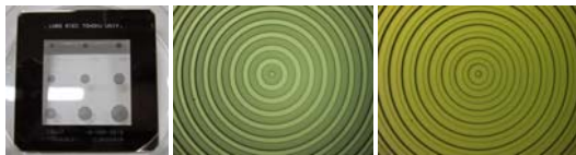
図 4 露光用マスク（周期 160~240 \mu\text{m} ）と紫外露光により作製した SU-8 パターン、および金膜を蒸着したテラヘルツ帯共振器
