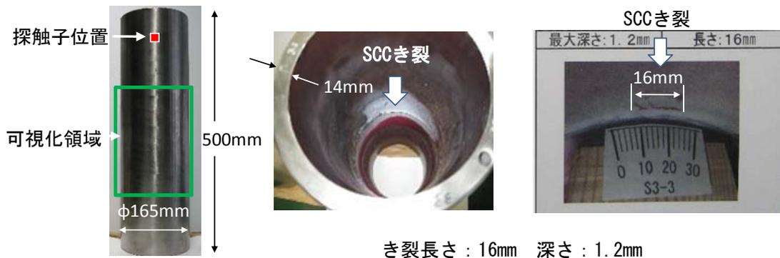
図4 溶接継ぎ手部に SCC き裂を有する SUS316 ステンレス鋼管試験体
