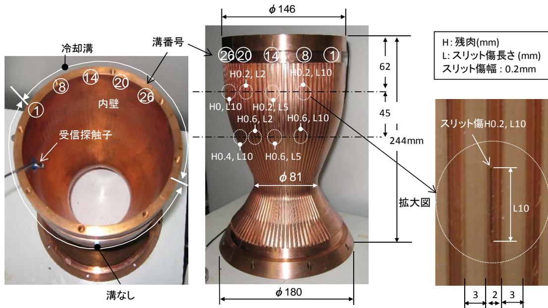
図6 液体ロケット燃焼器模擬試験体
