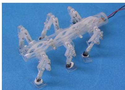
図4 壁面歩行ロボット
