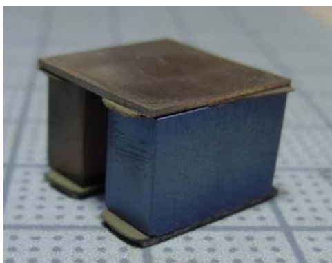
図4 NaCo_2O_4 と0.5at%Sbドープ Mg_2Si 熱電変換材料を用いて作製した \pi 形モジュールの光学写真
