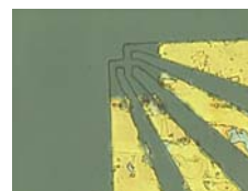
図 4 ホールプローブ (左) と 温度特性
