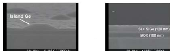
(a) Si上に直接Ge層成長 (b) Si上に濃度傾斜 \text{Si}_{1-x}\text{Ge}_x 層成長
