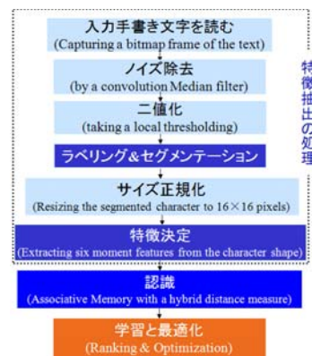
図 15 . 手書き文字の認識と学習を有する VLSI プレインの処理の流れ .
