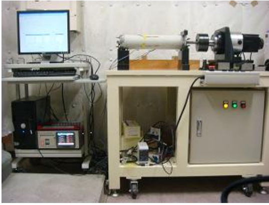
写真-1 持続荷重試験装置
