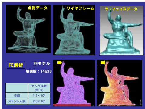
図6 3D計測データを用いたFE解析
