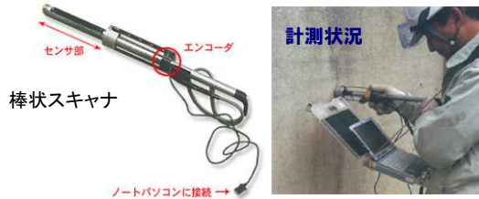
図5 棒型スキャナによる微非破壊検査
