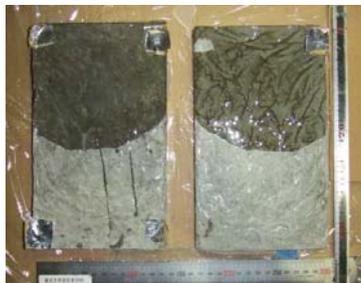
(c) 幅 0.5mm のひび割れへの注入
