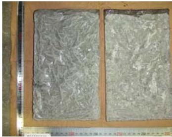
(a) 幅 0.05mm のひび割れへの注入
