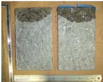
(b) 幅 0.2mm のひび割れへの注入
