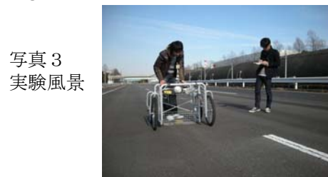
Fig.8 一体化移動可能とした音響計測装置
