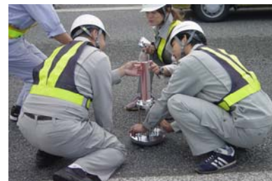
写真1 現場透水試験の実施例 (交通遮断は避けられない)
