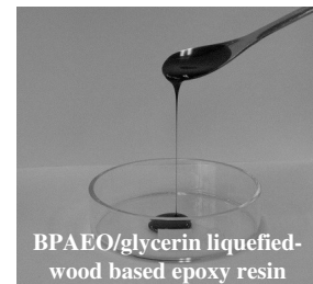
図11 BPAEO/グリセリン液化木材エポキシ樹脂の室温流動性
